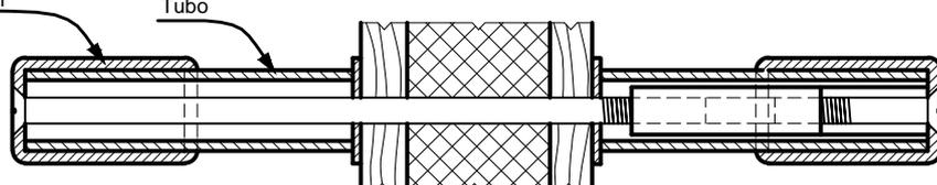
CORTE E PLANO QUE MOSTRAM A FIXAÇÃO DO PUXADOR: escala 1:2 para todas as medidas
